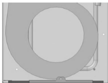
Position des Filters beim AirBlue SBA
