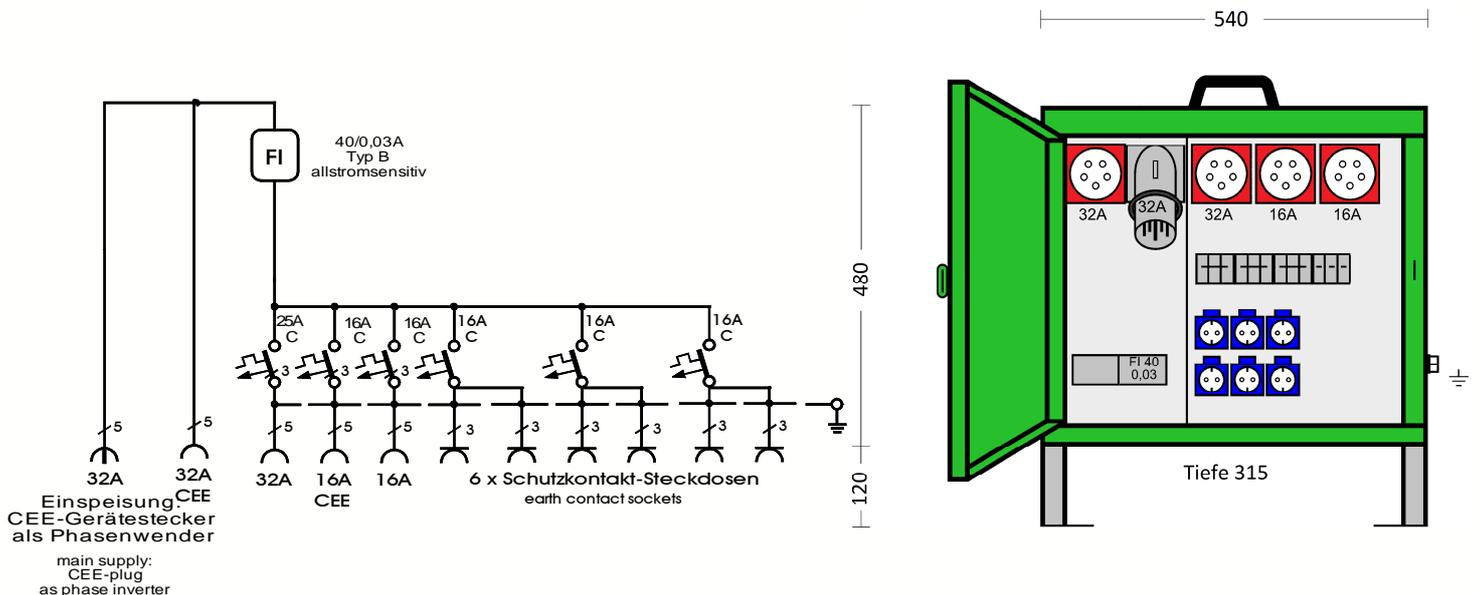
**ELEKTRA** - Endverteilerschrank im Gehäuse aus verzinktem Stahlblech, pulverbeschichtet RAL 6018, bestückt mit:
