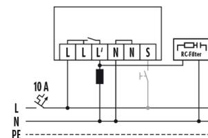
Standardbetrieb mit optionaler Ansteuerung durch Schließetaster und Parallelschaltung von max. 6 Geräten
