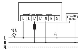
Bei Schaltung von Induktivitäten (z. B. Relais, Schütze, Vorschaltgeräte) kann der Einsatz eines Löschgliedes (RC-Filter) erforderlich sein.
