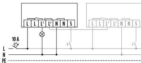
Standardbetrieb mit optionaler Ansteuerung durch Schließtaster und Parallelschaltung von max. 10 Geräten
