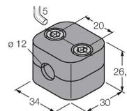
Befestigungsschelle für Glatt- und Gewinderohrsensoren; Werkstoff: Polypropylen
