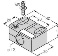
Befestigungsschelle für Gewinderohrsensoren, mit Festanschlag; Werkstoff: PA6
