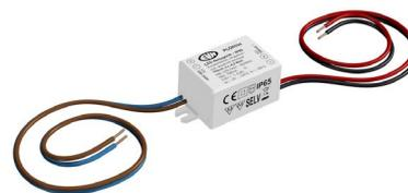
Der kurzschlussfeste Sicherheitstransformator lässt sich auf Grund der höheren Schutzart problemlos im Außenbereich einsetzen, kann aber z. B. auch beim Möbelbau verwendet werden, da die MM-Kennzeichnung gegeben ist. Die Anschlussleitungen haben eine Länge von 18cm primärseitig und 18cm sekundärseitig. Technische Daten: Versorgungsspannung: 220-240V/AC, ta: -20°C - 50°C, tc: 80°C, Powerfaktor 0,90.
