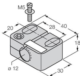
Befestigungsschelle für Gewinderohrsensoren, mit Festanschlag; Werkstoff: PA6
