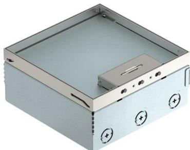
Quadratischer Bodentank für den Einsatz in trocken gepflegten Hohlböden und Estrichböden im Innenbereich. Einbaugehäuse mit vorgeprägten Einführungsöffnungen für Rohre (M25). Mit 2 Universalträger UT3 45 3 und einer 3-fach Schutzkontaktsteckdose. Oberteil durch 4 Nivellierstützen auf Oberkante Bodenbelag einstellbar. Die Mindesteinbautiefe beträgt 95 mm, der Nivellierbereich + 30 mm.
