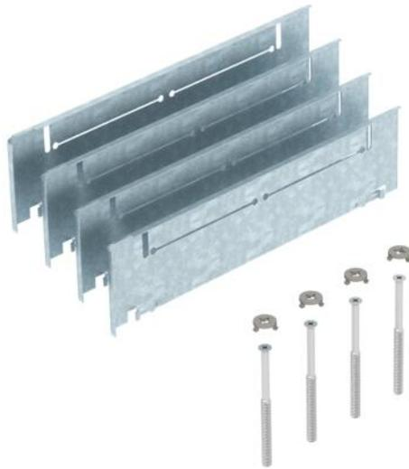
Höhenausgleich-Bausatz für Unterflurdosen UZD250-3 und UGD250-3 mit einer Bauhöhe von 70 bis 125 mm für die bauseitige Erhöhung der UZD/UGD auf eine Höhe von 115-170 mm, bestehend aus 4 Fallblechen, 4 Nivellierschrauben und 4 Drehverschlüssen.
