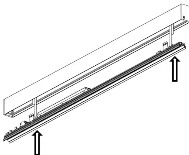
Lichteinsatz einhängen. Blechhalter in mittlere Nut einsetzen
