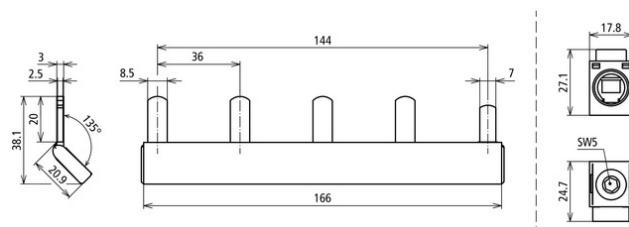
Modularverdrahtungsbügel für TT-Systeme, isoliert, einphasig, vierpolig mit Anschlussklemme bis 50 mm<sup>2</sup>.
