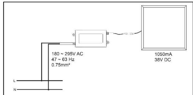
C. Anschluss dim 1-10V
