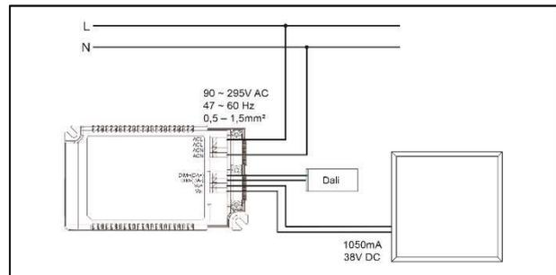
E. Anschluss an einen beliebigen 1050mA Konstantstrom LED-Betriebsgeräte
