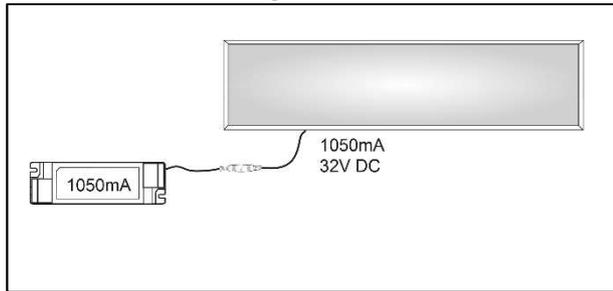
\*Schließen Sie die Leuchte nicht an ein eingeschaltetes LED-Betriebsgeräte an. Einige LED-Betriebsgeräte geben im Leerlauf eine hohe Spannung ab, was zu einer dauerhaften Beschädigung der Leuchte führen kann. Trennen Sie den LED-Betriebsgeräte unbedingt von der Netzleitung, bevor Sie die Leuchte anschließen.
