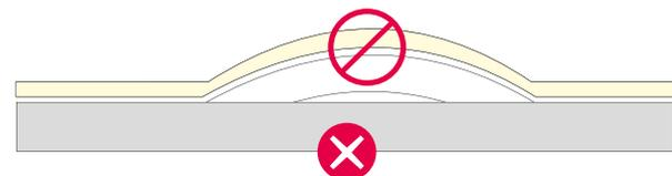
Der LED-Strip ist aus **einer** Installationsrichtung gleichbleibend zu verarbeiten, um einen Materialüberschuss zu verhindern.
