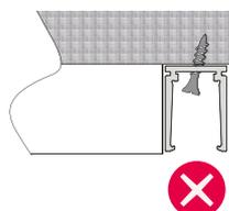
Die Schraube muss gerade eingeschraubt werden damit Sie nicht über die Montagelinie hinausragt.
