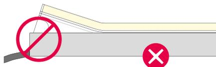
Es ist Verboten, die Einspeisung **ST, SL, SR, SU** sowie die **Endkappe** einer Verschweißten Einspeisung mit Gewalt ins Profil zu setzen und damit das LED-Lichtband zu deformieren.
