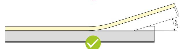
Der Installationswinkel muss **kleiner** als 15° sein, während das LED-Band per Hand in das Profil gedrückt wird, um eine Schädigung der Platine zu verhindern.
