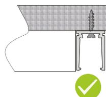
Verschrauben Sie das Profil mit dem Montageuntergrund und stellen Sie sicher, dass die Schraube bündig oder tiefer als die Montagelinie liegt.
