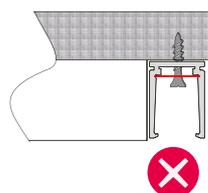
Der Schraubenkopf darf nicht über die Montagelinie drüber hinausragen.
