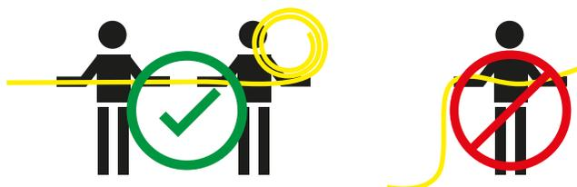
LED-Strip darf **nicht** durchhängend montiert werden. Eine Montage mit zwei Personen um ein Durchhängen zu **verhindern** wird empfohlen.
