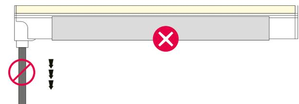
Die Zuleitung darf mit keiner mechanischen Belastung (auf Zug) verbaut werden. Es ist verboten, die Leitung mit übermäßiger Kraft stark abzuknicken. Es ist empfohlen die Leitung erst nach 60mm in zulässigen Installationsradien zu verlegen.
