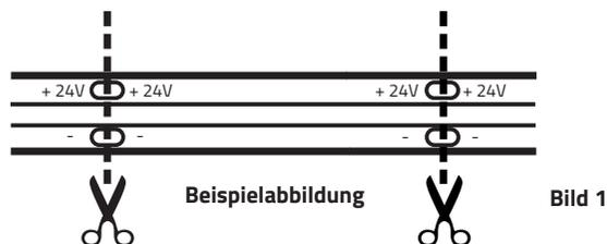
**VARDAFLEX** LED-Strip an der markierten Stelle trennen. Bei eng bestückten LED-Strips wird ein Mikroseitenschneider oder optional ein Cutter benötigt!
