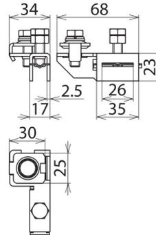
Zum Kombinieren mit Endlos-Spannband (Art.-Nr. 540 901), Anschlussquerschnitt 4-50 mm<sup>2</sup> (ein- / mehrdrätig).
