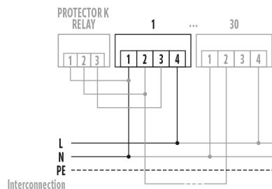
230 V Anschluß. Optional: Vernetzung mit max. 30 Meldern (max. Leitungslänge 300 m) und PROTECTOR K RELAY.
