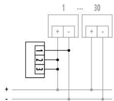
Batteriebetrieb 9 V.Externes Schaltrelais zum Schalten von externen Geräten wie z. B. Sirenen, Blinkleuchten und Telefonwählgeräten.
