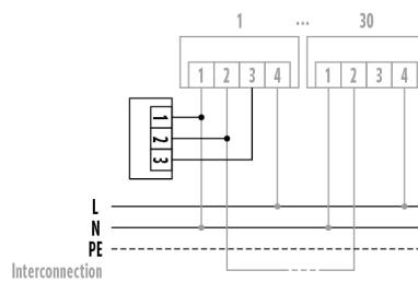
230 V Anschluß. Externes Schaltrelais zum Schalten von externen Geräten wie z. B. Sirenen, Blinkleuchten und Telefonwählgeräten.
