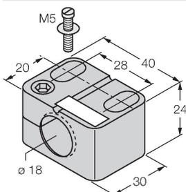
Befestigungsschelle für Gewinderohrsensoren, mit Festanschlag; Werkstoff: PA6
