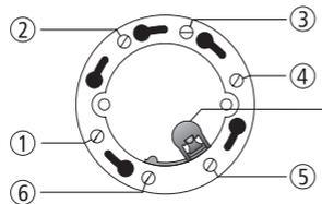
Magnethalter für Leitungsüberwachung eingesetzt im letzten Rauchschaltersockel des Stiches. Der Magnethalter ist im Lieferumfang des Sockels enthalten.
