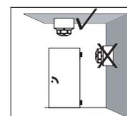
Der Rauchschalter ORS 142 darf gemäß Abbildung nur auf eine waagrechte Fläche montiert werden. Des Weiteren wird empfohlen einen Abstand von 0,5 m zu jeglichen Installationen einzuhalten.
