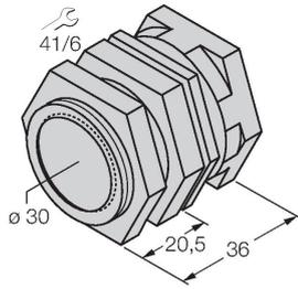
Schnellmontagehalterung mit Festanschlag; Werkstoff: Messing verchromt. Außengewinde M36 x 1,5. Hinweis: Der Schaltabstand der Näherungsschalter kann sich durch Verwendung von Schnellmontagehalterungen ändern.
