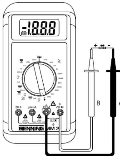
Bild 7: Diodenprüfung
