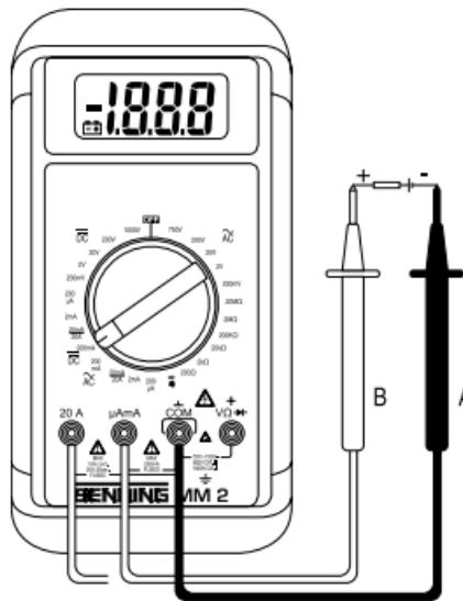
Bild 4: Gleichstrommessung
