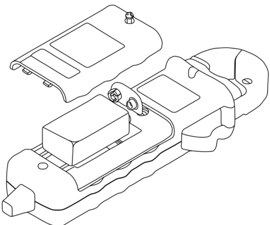
Bild 3: Batteriewchsel
