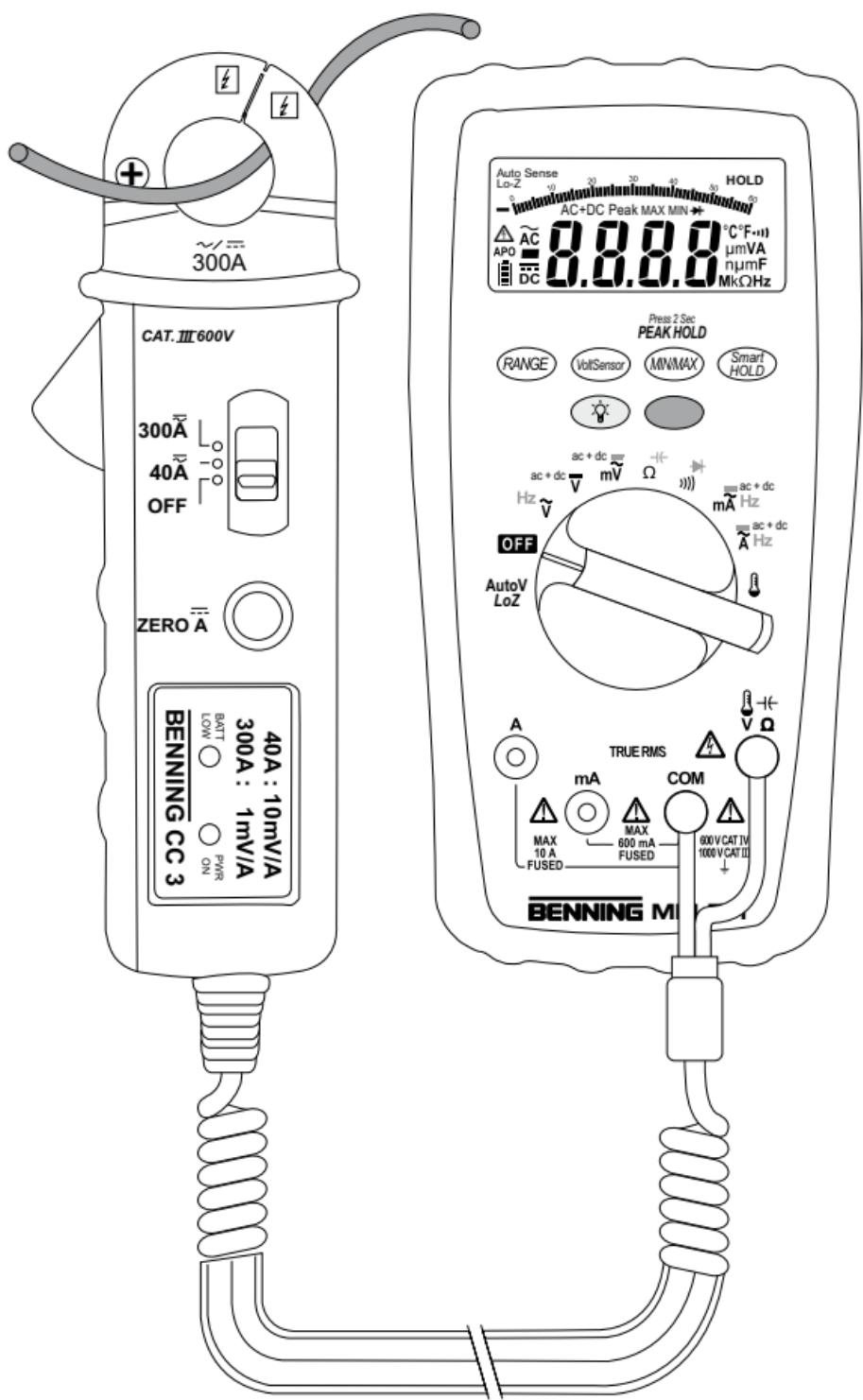
Bild 2: Gleich-/ Wechselstrommessung
