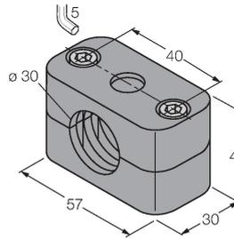
Befestigungsschelle für Glatt- und Gewinderohrsensoren; Werkstoff: Polypropylen
