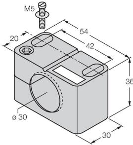
Befestigungsschelle für Gewinderohrsensoren, mit Festanschlag; Werkstoff: PA6
