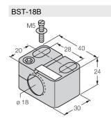
6947214 Befestigungsschelle für Gewinderohrsensoren, mit Festanschlag; Werkstoff: PA6
