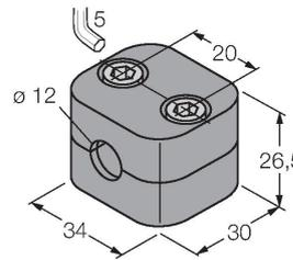
Befestigungsschelle für Glatt- und Gewinderohrsensoren; Werkstoff: Polypropylen
