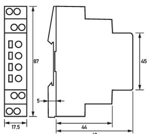
Maßzeichnung Unterspannungsmessrelais RUR 1
