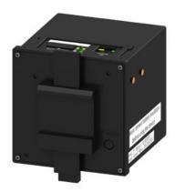
SENTRON, Messgerät und power quality recorder, 7KM PAC5200, Hutschienengehäuse ohne Display, L-L: 690 V, L-N: 400 V, 10 A, Hutschienengerät, 3- phasig, Modbus TCP, Schein- / Wirk- / Blindenergie / cos phi, Oberschwingungen: 2. - 40., THD, Klasse 0,5 gem. IEC61557-12 bzw. Klasse 0,5S gem. IEC62053-22, Weitspannungsnetzteil, AC/DC, Schraubanschluss
