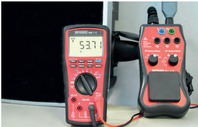
Tastverhältnismessung des CP-Steuersignals einer Wallbox
