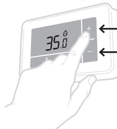
Anschließend die **-** Taste drücken, um die niedrigste Temperatur einzustellen und **den Boiler auf den Betrieb hin prüfen** - Das Symbol „Heizbedarf“ am Thermostat ist daher **ausgeschaltet**.
