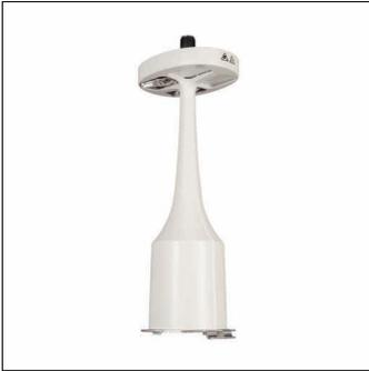
Baugruppe Elektrik, für Modul 540 iQ, Geräte-Träger, Vorschaltgerät: EVG iQ, LED Lichtstrom: 1.610 lm, Farbtemperatur: 4000K, mit Klemme, 6polig, max. 2,5mm<sup>2</sup>, Netzanschluss: 230..240V, AC, 50/60Hz, Beginn der Lebensdauer: 10 W, Ende der Lebensdauer: 10 W, Reduzierung: 5 W, primäre Lichtcharakteristik: asymmetrisch, Breite: 190 mm, Höhe: 514mm, Schutzklasse (gesamt): SK II (Schutzisoliert), Prüfzeichen: CE, ENEC, VDE
