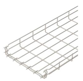
Gitterrinne mit angeformtem Verbinder in der Seitenhöhe 55 mm. Für die Gitterrinne werden keine zusätzlichen Verbinderbauteile benötigt, sie wird einfach ineinandergesteckt. Die Maschenweite beträgt 50 x 100 mm (Ausnahme GRM 55/50 = 20 x 100 mm).
