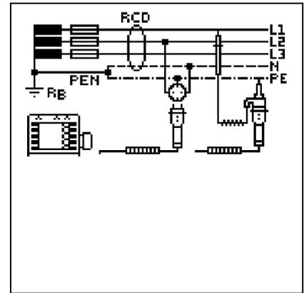
Ein RCD-Schalter kann nur in einem TN-S-Netz eingesetzt werden. In einem TN-C-Netz würde ein RCD-Schalter nicht funktionieren, da der PE nicht am RCD-Schalter vorbei geführt ist, sondern direkt in der Steckdose mit dem N-Leiter verbunden ist. So würde ein Fehlerstrom durch den RCD-Schalter zurückfließen und keinen Differenzstrom erzeugen, der zum Auslösen des RCD-Schalters führt.
