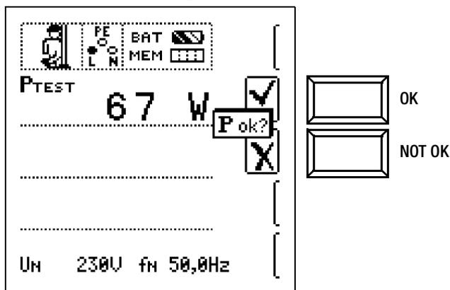
Bei Bewertung mit „NOT OK“ erfolgt eine Fehlersignalisierung über die rot leuchtende LED UL/RL.
