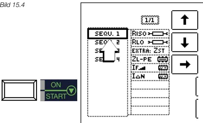
Mit der Taste **START** wird die ausgewählte Prüfsequenz (hier: SEQU.1) gestartet.
