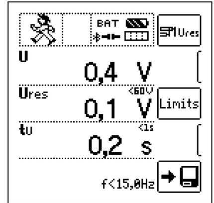
Die Prüfung ist als Dauermessung eingestellt, da die Restspannungsprüfung automatisch getriggert wird und die Spannungsmessung aus Sicherheitsgründen immer aktiv bleibt.
