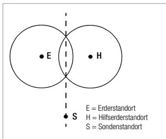
Bild 10.8.3 Sondenabstand S außerhalb der sich überschneidenden Spannungstrichter auf der Mittelsenkrechten zwischen Erder E und Hilfserder H
