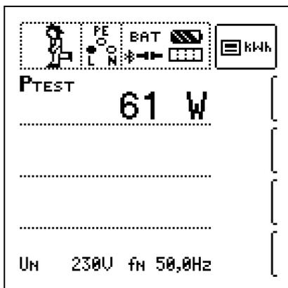
Der Zähler wird mithilfe eines internen Lastwiderstands und einem Prüfstrom von ca. 250 mA geprüft. Nach Drücken der Taste Start wird die Prüfleistung angezeigt und Sie können innerhalb der nächsten 5 s prüfen, ob der Zähler ordnungsgemäß anläuft. Das Piktogramm für „RUN“ wird eingeblendet.
