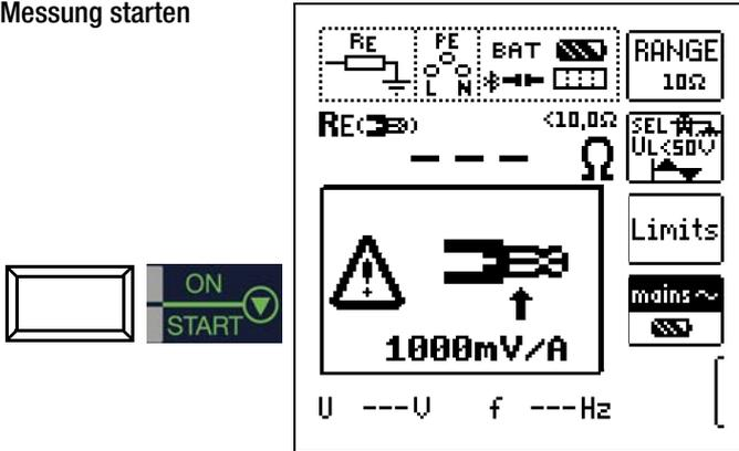
Sofern Sie die Wandlerübersetzung im Prüfgerät verändert haben, wird ein Popup-Fenster mit dem Hinweis eingeblendet, diese neue Einstellung auch am angeschlossenen Zangenstromsensor vorzunehmen.
