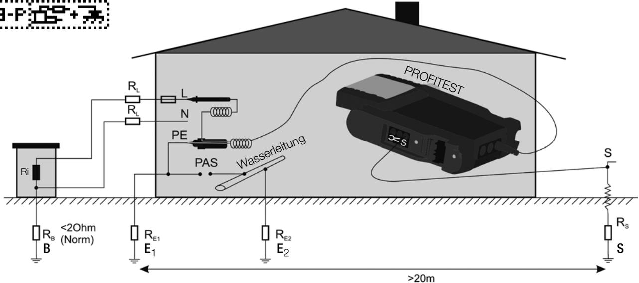
Diese Messung ist nur mit Sonde möglich, siehe Kap. 10.4. Die Erderspannung U<sub>E</sub> ist die Spannung die am Erder zwischen dem Erderanschluss und der Bezugs Erde auftritt, wenn zwischen Außenleiter und Erder ein Kurzschluss auftritt. Die Ermittlung der Erderspannung ist in der Schweizer Norm NIV/NIN SEV 1000 vorgeschrieben.
