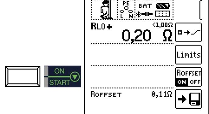
Während der Magnetisierungsphase (Kurvenanstieg) und der anschließenden Messphase (konstanter Strom) wird das Symbol rechts eingeblendet.
