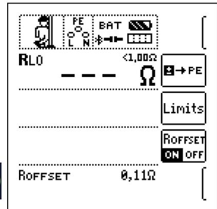
In der Fußzeile des Displays erscheint nun die Meldung **ROFFSET** x.xx Ω, wobei x.xx einen Wert zwischen 0,00 und 10,0 Ω annehmen kann. Dieser Wert wird nun bei allen nachfolgenden  $R_{LO}$ -Messungen vom eigentlichen Messergebnis subtrahiert, sofern Sie die Softkey-Taste **ROFFSET ON/OFF** auf **ON** geschaltet haben.
