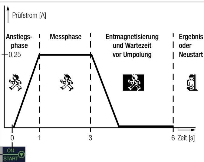
Darstellung der Mess- und Wartephases bei der Schutzleiterwiderstandsmessung an PRCDs mit dem PROFITEST MXTRA
