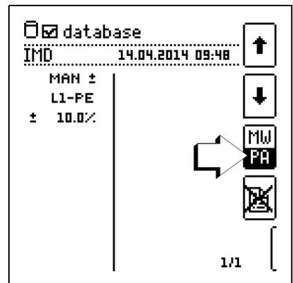
Über die nebenstehende Taste (MW: Messwert/PA: Parameter) können Sie sich die Einstellparameter zu dieser Messung anzeigen lassen.
