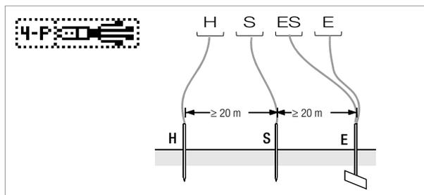
Bild 10.8.1 Messung des Erdungswiderstandes nach dem Vierleiterverfahren
