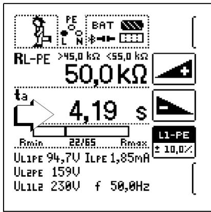
Die Messung kann durch Drücken von ON/START oder ESC abgebrochen werden.
