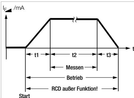
Unterdrückung der RCD-Auslösung bei pulsstromsensitiven RCD-Schutzschaltern
