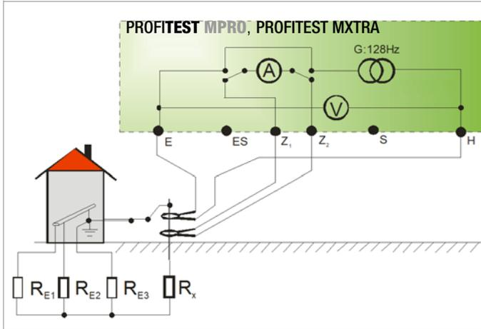
Bei Erdungsanlagen, die aus mehreren miteinander verbundenen Erden ( $R_1 \dots R_x$ ) bestehen, kann der Erdungswiderstand eines einzelnen Erders ( $R_x$ ) mithilfe von 2 Stromzangen ermittelt werden, ohne  $R_x$  abzutrennen oder Spieße zu setzen. Diese Messmethode eignet sich besonders bei Gebäuden oder Anlagen, bei denen Sonden und Hilfserder nicht gesetzt werden können oder Erder nicht aufgetrennt werden dürfen.
