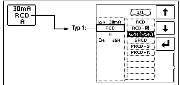
Berührungsspannung und Auslösezeit können mittels G/R-RCD-Schalter-Einstellung gemessen werden.
