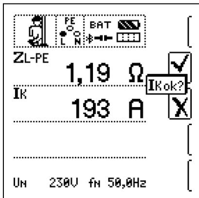
Der Kurzschlussstrom  $I_K$  dient zur Kontrolle der Abschaltung einer Überstrom-Schutzeinrichtung. Damit eine Überstrom-Schutzeinrichtung rechtzeitig auslöst, muss der Kurzschlussstrom  $I_K$  größer als der Auslösestrom  $I_a$  sein (siehe Tabelle 6 Kap. 21.1). Die über die Taste „Limits“ wählbaren Varianten bedeuten:
