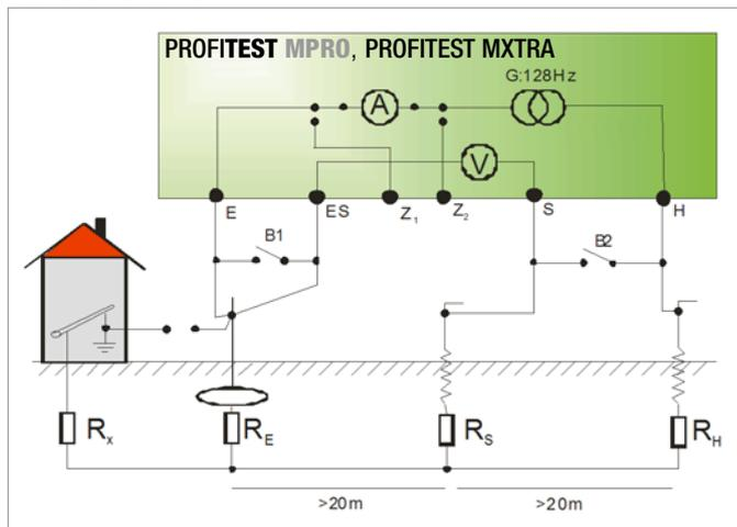
Das Vierleiterverfahren wird eingesetzt bei einem hohen Zuleitungswiderstand vom Erder zum Geräteanschluss.
