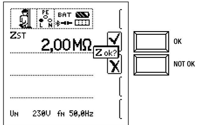
Die Widerstandswerte sind an mehreren Stellen zu messen, damit eine ausreichende Beurteilung möglich ist. Der gemessene Widerstand darf an keiner Stelle den Wert von 50 kΩ unterschreiten. Ist der gemessene Widerstand größer als 30 MΩ, so wird im Anzeigefeld immer Z<sub>ST</sub> > 30.0 MΩ angezeigt.
