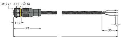
Anschlussleitung, M12-Kupplung, gerade, 3-polig, Leitungslänge: 2m, Schutzmantelmaterial: Aramidfasern, gelb; Temperaturspitze: 200°C; andere Leitungslängen und Ausführungen lieferbar, siehe [www.turck.com](http://www.turck.com)
