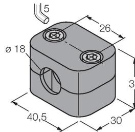
Befestigungsschelle für Glatt- und Gewinderohrsensoren; Werkstoff: Polypropylen
