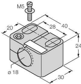
Befestigungsschelle für Gewinderohrsensoren, mit Festanschlag; Werkstoff: PA6
