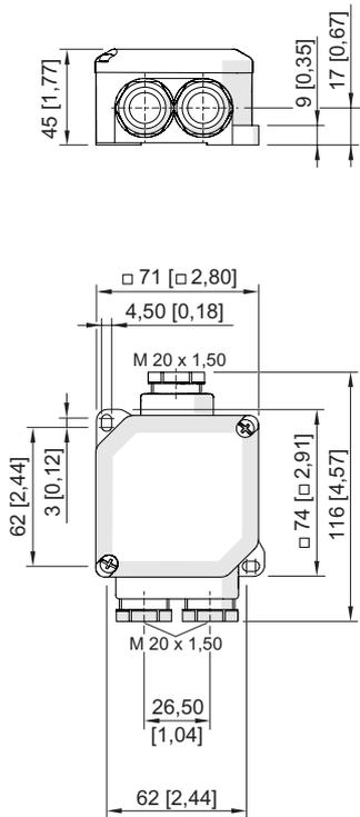
mit Halbverschraubungen 3 x M20
