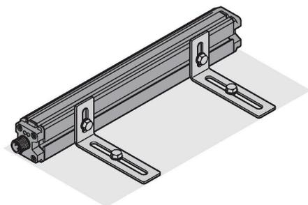
Umfangreiches Montagezubehör ermöglicht vielfältige Einbaumöglichkeiten. Bedingt durch das Messprinzip, das auf einer Schwingkreiskopplung basiert, ist der Linearwegsensor unempfindlich gegenüber aufmagnetisierten Eisenteilen oder sonstigen Störfeldern.
