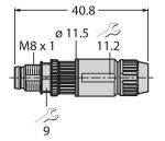
Konfektionierbarer Stecker, M8 x 1, gerade, 4-polig, Schneidklemmanschluss, Leitungsdurchlass 2.5 bis 5.1 mm, Adernquerschnitt/ Klemmvermögen 0.14 bis 0.34 mm², Kunststoffgehäuse, Metallüberwurfmutter
