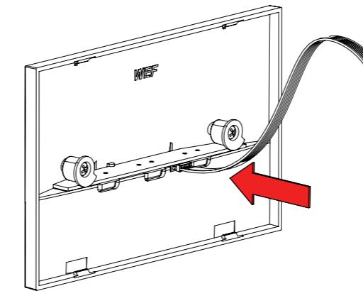
7-pol. Kabel an die Platine anschließen.
