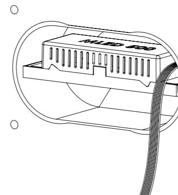
Elektronik anschließen und einsetzen. Ggf. die Laschen abwickeln.
