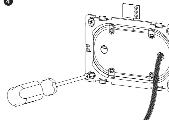
Universalrahmen darüber platzieren und verschrauben. Den Prüf-
