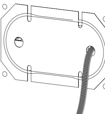
Transparente Isolierfolie ansetzen und 7-pol. Kabel durch ein Loch
