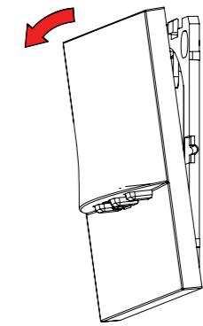
WEF-Metall-Lampe nach oben drücken und aushebeln. Ggf. mit
