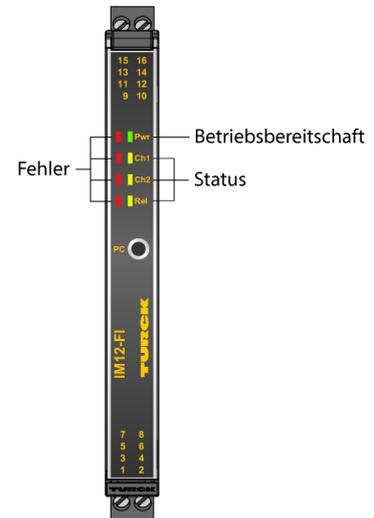
Der Frequenzmessumformer/Puls-Counter IM12-FI01-1SF-1I1R-C0/24VDC überträgt Frequenzsignale bis 20000 Hz galvanisch getrennt. Zusätzlich können Grenzwerte, Schlupf oder Rechts-/Links-Lauf überwacht werden. Die Geräte sind für den Betrieb in Zone 2 geeignet.
