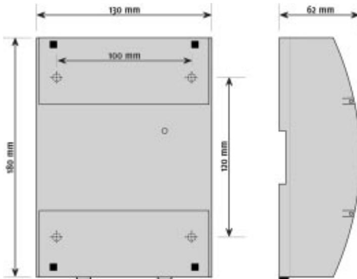
Klappen Sie die Deckel des Gerätes auf. Bohren Sie Befestigungslöcher gemäß Bohrbild, bzw. befestigen Sie das Gerät auf einer Hutschiene.
