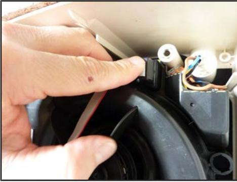
3. Montieren Sie die im Lieferumfang enthaltene Befestigungsabdeckung rechts oben mit der dazugehörigen Linsenschraube. Achten Sie vor Montage der Befestigungsabdeckung darauf, das Flachkabel durch die vorgesehene Nut zu führen. **Hinweis:** Dies gilt ausschließlich für die Abdeckungen ER-AK/ER-AH und ER-AB.
