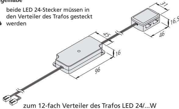
zum 12-fach Verteiler des Trafos LED 24/...W
