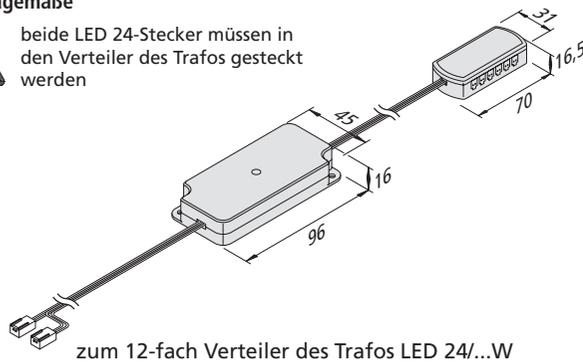
zum 12-fach Verteiler des Trafos LED 24/...W
