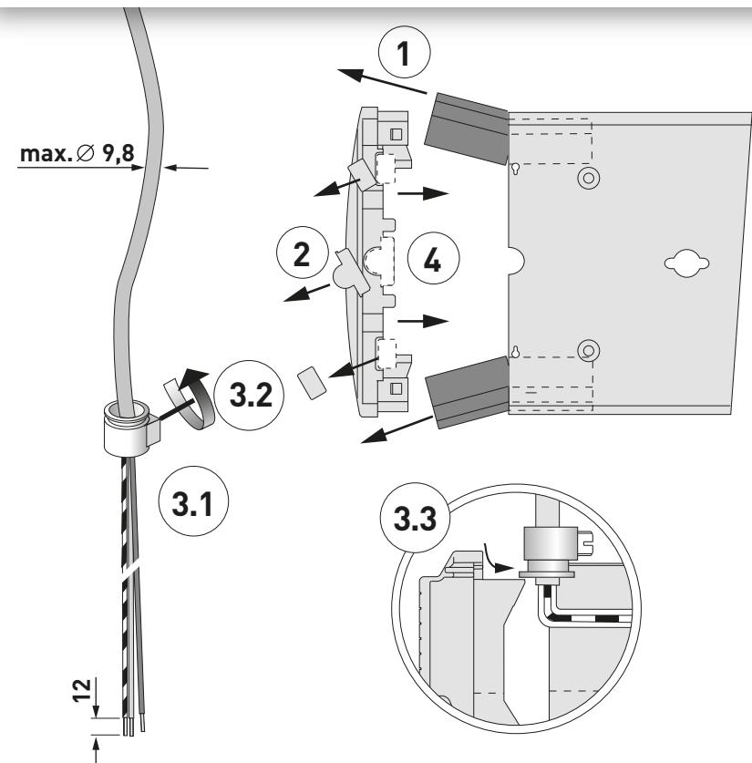
**de** Leitung ist bauseits zu stellen. Flexible Leitungen mit Aderendhülsen verwenden. Leitung darf nicht am Vorschaltgerät vorbeiführen. Kabelhalter nutzen.
