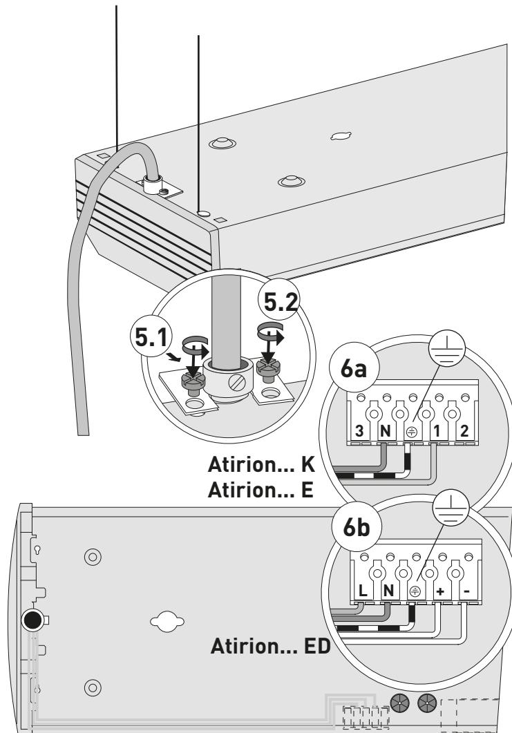
**(de)** Durchgangsverdrahtung darf nicht am Vorschaltgerät oder Ausgleichsgewicht anliegen.
