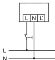
Standardbetrieb mit zusätzlicher Möglichkeit des Einschaltens von Hand.
