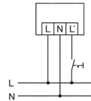
Standardbetrieb mit zusätzlicher Dauerlichtfunktion durch externen Schalter.
