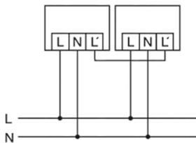
Parallelschaltung von Automatikleuchten
