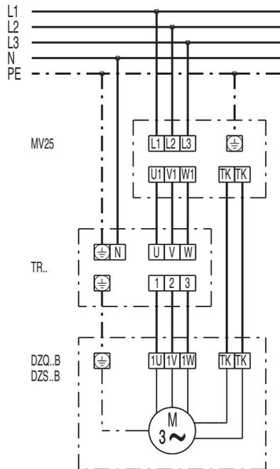
**DZQ / DZS..B mit 5-Stufentransformator, Schaltschrank TR..S, 5-Stufenschalter DSS 20 und Motorvollschutzschalter MV 25**
