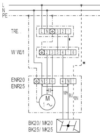
TRE - 5-Stufentransformator (Ein/Aus, 5 Drehzahlen)
