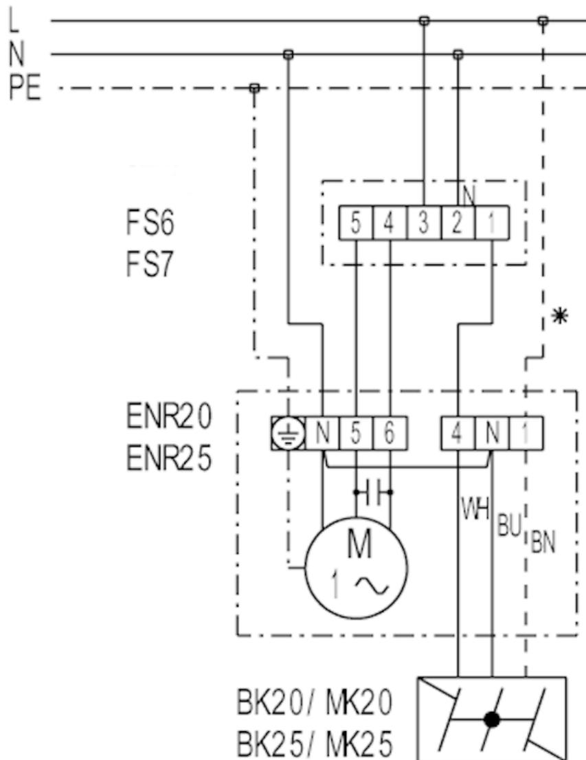
FS 6 - Stufenschalter (2 Drehzahlen, Ent-/Belüftung)
