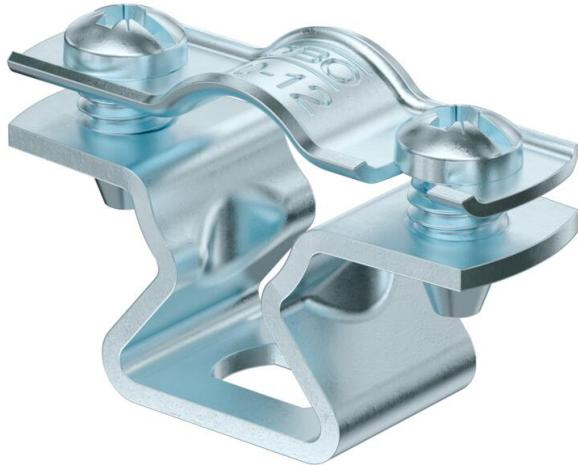
Abstandschelle zur Montage von Rohren und Kabeln an Wand, Decke und Boden. Mit selbstsicherndem Oberteil. Befestigung über Langloch. Zugelassen für den Funktionserhalt nach DIN 4102 Teil 12, Funktionserhaltklassen E 30 bis E 90.
