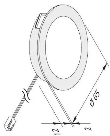
bei Dämmung Abstandshalter min. 50 mm verwenden
