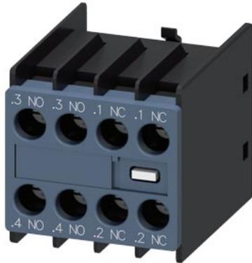
Hilfsschalter, frontseitig, 2 S + 2 Ö, .3/.4, .3/.4, .1/.2, .1/.2, Strombahn: 1 S, 1 S, 1 Ö, 1 Ö, Schraubanschluss, für Schütze 3RT2 und Hilfsschütze 3RH2
